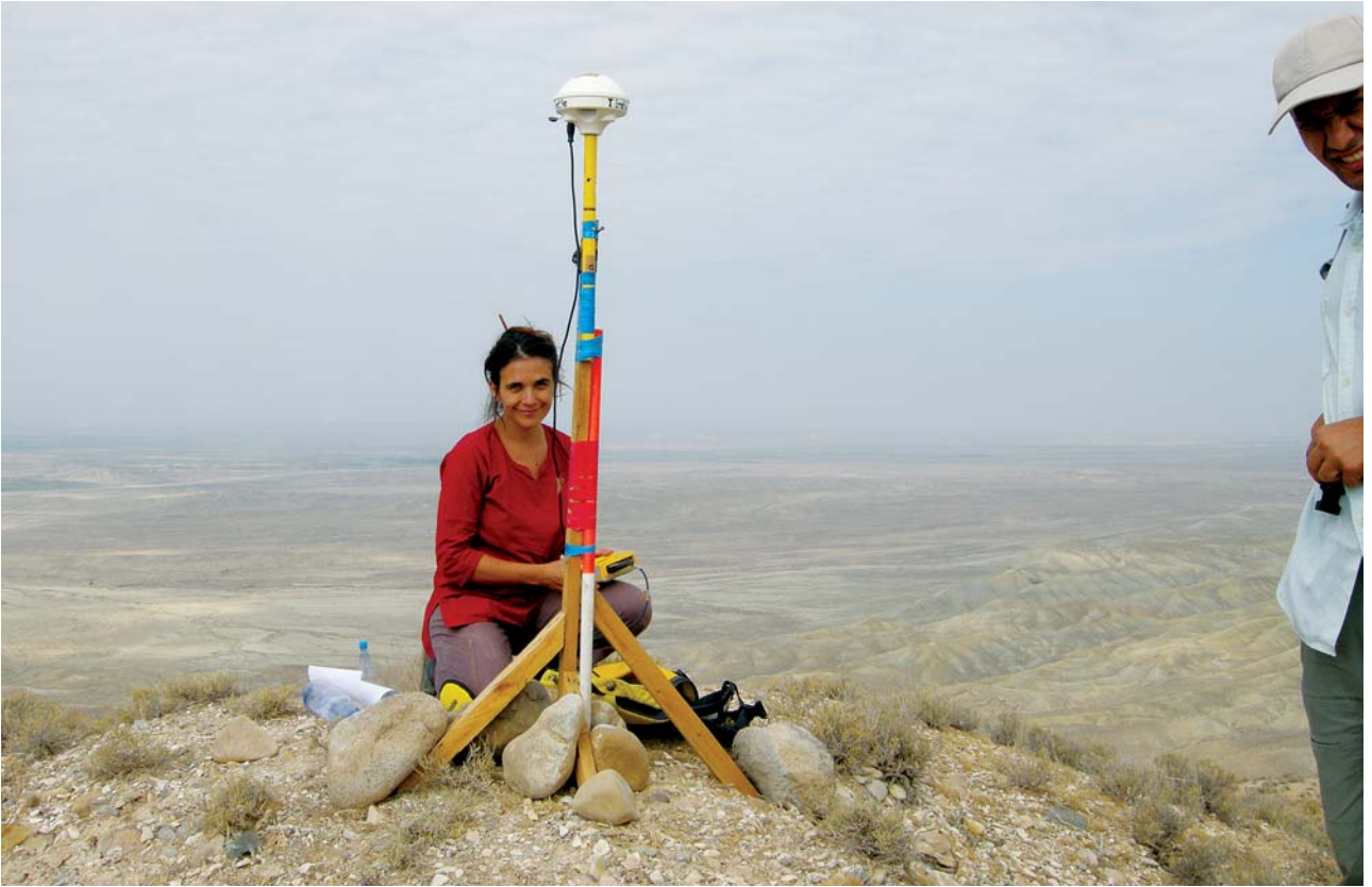
Şəkil 25. DGPS-in hazırlanması. Figure 25. Setting up the DGPS.
